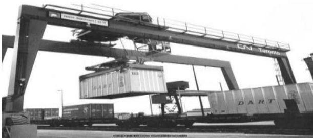
شکل (۵). بارگیری کانتینر ۲۴ فوت روی واگن مسطح در بندر یا پایانه ریلی [۲۴]
