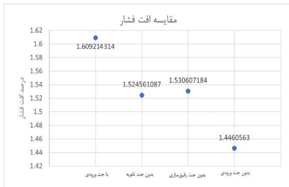
شکل (۱۰): مقایسه افت فشار بین محفظه‌های با ورودی هوای جانبی متفاوت
