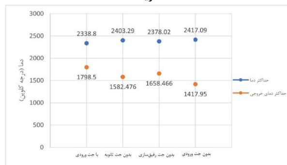
شکل (۹): مقایسه دما بین محفظه‌های با ورودی هوای جانبی متفاوت
