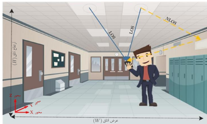
شکل (۱). مدل سیستم VLC محیط بسته شامل چندین LED در سقف و یک گیرنده متحرک که به‌طور تصادفی در محیط قرار می‌گیرد
