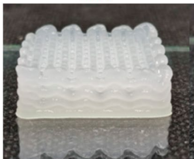
شکل (۸): شماتیک فرایند تولید آئروژل CMC حاوی کیتوزان-نانونقره با استفاده از پرینت سه بعدی (الف) و شکل ظاهری آئروژل قبل و بعد از خشک کردن انجمادی (ب) [۷۶]
