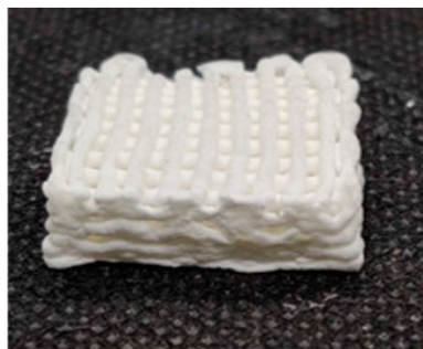
شکل (۸): شماتیک فرایند تولید آئروژل CMC حاوی کیتوزان-نانونقره با استفاده از پرینت سه بعدی (الف) و شکل ظاهری آئروژل قبل و بعد از خشک کردن انجمادی (ب) [۷۶]
