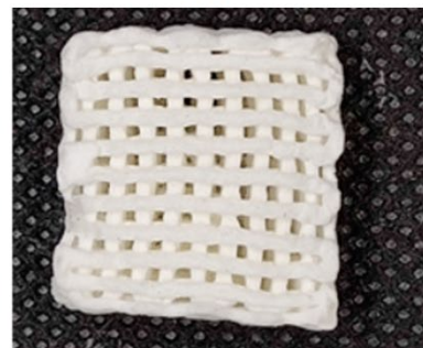
شکل (۸): شماتیک فرایند تولید آئروژل CMC حاوی کیتوزان-نانونقره با استفاده از پرینت سه بعدی (الف) و شکل ظاهری آئروژل قبل و بعد از خشک کردن انجمادی (ب) [۷۶]
