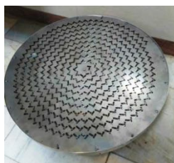
شکل (۲۶). ساختار آنتن آرایه‌ای شکاف‌دار خطی شعاعی توان بالا
