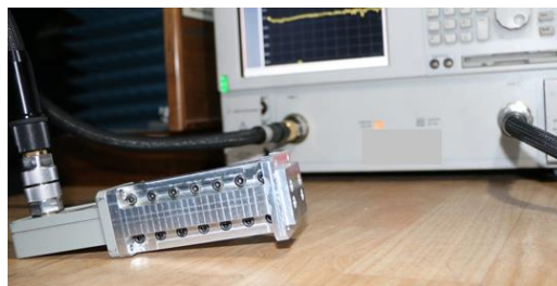
شکل (۴). نمایش چیدمان تست المان با ابزار شبیه‌ساز موج‌بری [۲]
