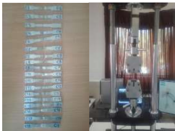
شکل (۸): نمونه‌های آزمایش کشش پس از آزمایش.
