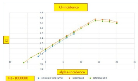
شکل (۱۰): نمودار تغییرات نیروی برآ بر حسب زاویه حمله برای حل عددی و مرجع عددی و تجربی
