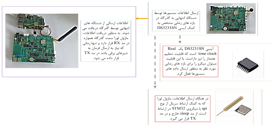
شکل (۴). نحوه عملکرد کلی دستگاه انتهایی
