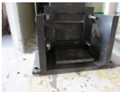
شکل (۳): نگه‌دارنده مورد استفاده در این آزمایش
