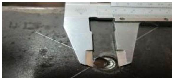
شکل (۱۳): سوراخ به قطر ۷ میلی‌متر و همپوشانی ۶ میلی‌متر
