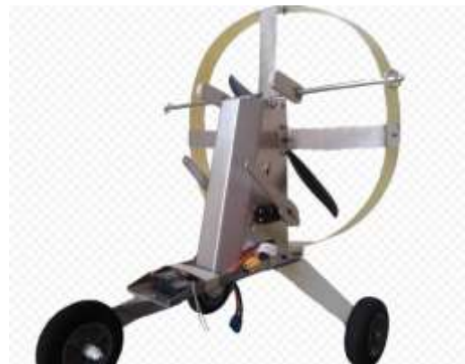
شکل (۱۱): قسمت محموله شامل ۱ موتور براشلس به همراه ملخ، ۲ عدد سروموتور و تجهیزات جانبی.
