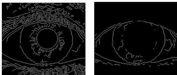
شکل ۶. (الف) مرز پس از حذف لبه‌های مربوط به مردمک، (ب) پلک‌ها و مرزهای به‌دست‌آمده با استفاده از لبه‌یاب Canny.
