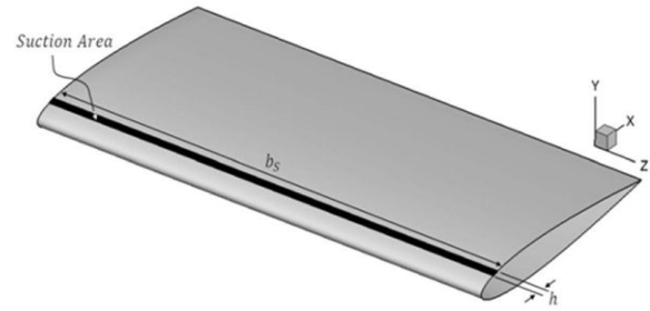
شکل (۸): بال با ایرفویل NACA0012 به همراه شیار مکش [۱۱]
