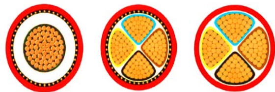
شکل (۱): سطح مقطع سه نوع کابل با هسته‌های مختلف
