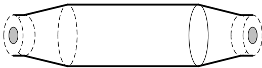
شکل (۲): افزایش قطر در محل اتصال مفصل
