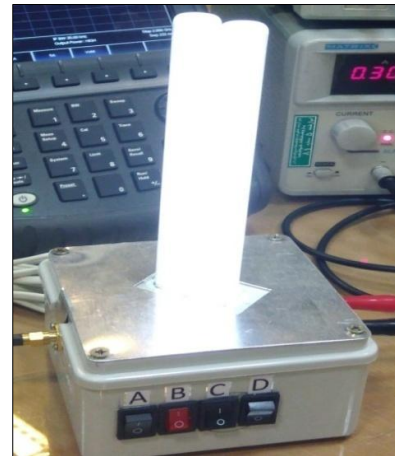
شکل (۶): نمای واقعی آنتن پلاسمایی ساخته شده
