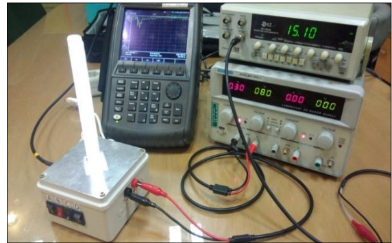
شکل (۹): اندازه‌گیری پارامترهای آنتن با دستگاه VNA
