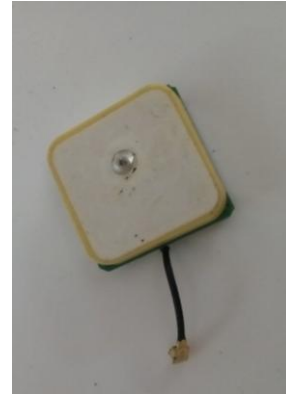
شکل (۲): آنتن Patch مربوط به GPS رادیوسوند
