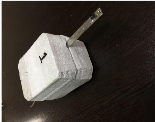
شکل (۹): نمای بیرونی بدنه یونولیتی یک نمونه رادیوسوند.
