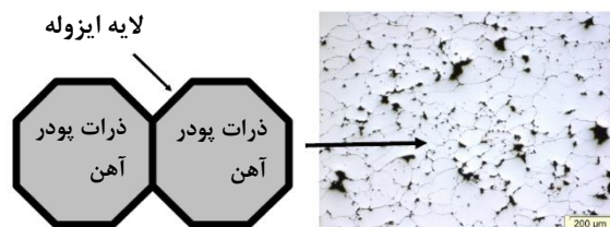
شکل (۲): ذرات احاطه‌شده پودر آهن در ماده عایق.
