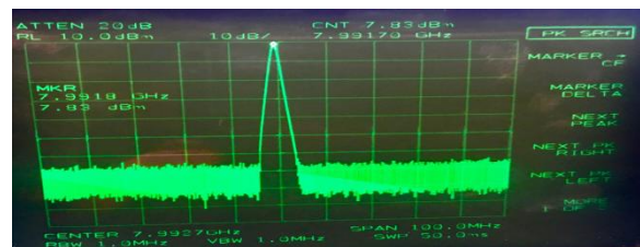
شکل (۱۷): توان خروجی نوسانساز فعال با وجود یک عنصر فعال
