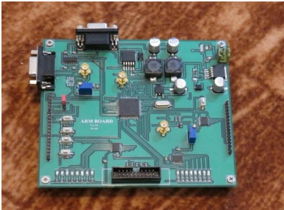
شکل (۱): بورد مبتنی بر پردازنده ARM طراحی شده در این پروژه.
