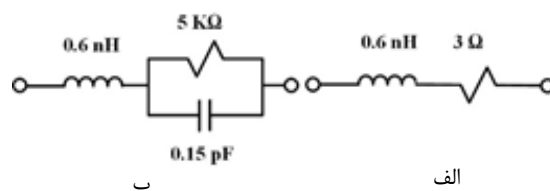
شکل ۹. مدار معادل دیود پهن، الف) وصل و ب) قطع
