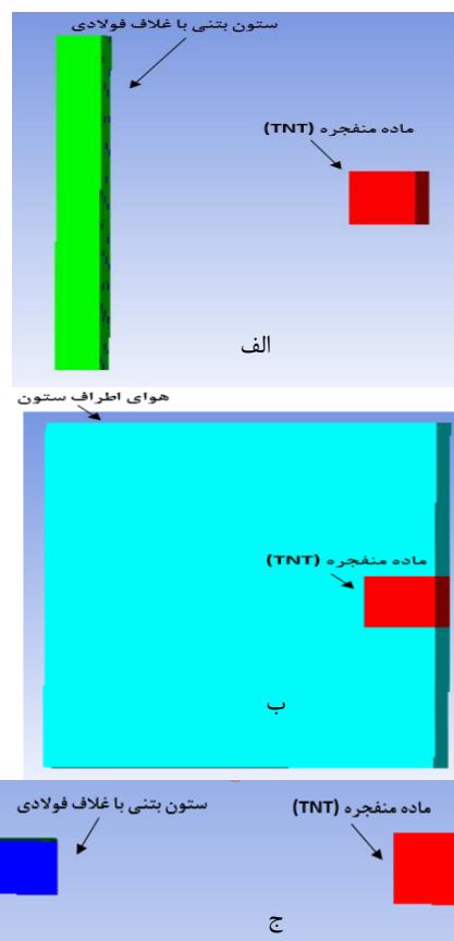
شکل ۲. مدل سازی الف) ستون و ماده منفجره ب) هوای اطراف ستون ج) نمای بالای ستون و ماده منفجره
