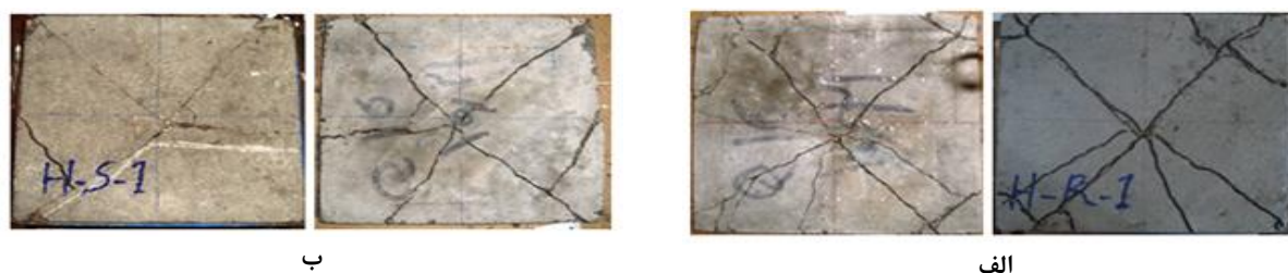
شکل ۸. الگوی گسیختگی نهایی؛ (الف) پانل H-S و (ب) پانل H-R بعد از ضربه اول؛ (چپ) وجه جلویی و (راست) وجه پشتی
