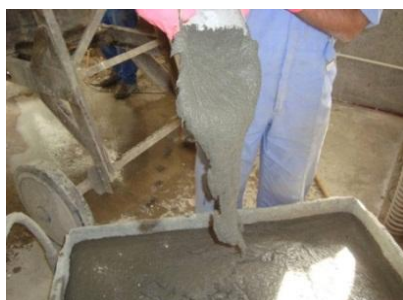
شکل ۱. مخلوط بتن فوق توانمند الیافی
