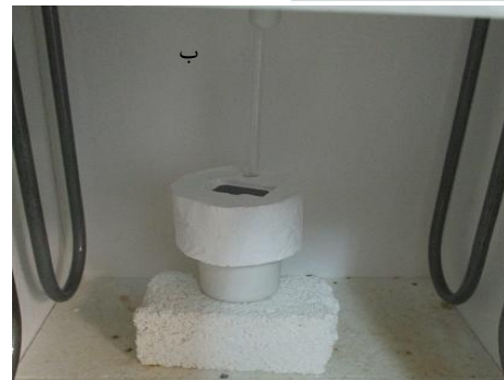
شکل ۲. الف) نحوه قرارگیری ویفرهای سیلیکونی در کوره اتمسفر کنترل استوانه‌ای و آرایش آن‌ها با بور و فسفر (ب) نمایی از داخل کوره برای آرایش سیلیکون
