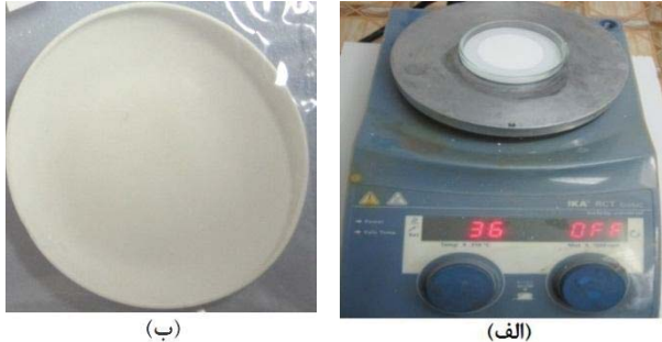
شکل ۱. الف) لایه کامپوزیتی در حال خشک شدن در دمای ۳۵ درجه سانتی‌گراد، ب) نمونه‌ای از لایه کامپوزیتی PVDF-CaCO 3 خشک شده و جدا شده از بشقابک شیشه‌ای
