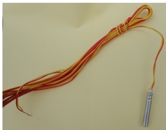
شکل ۵. تصویر چاشنی انفجاری مورد استفاده در آزمایش
