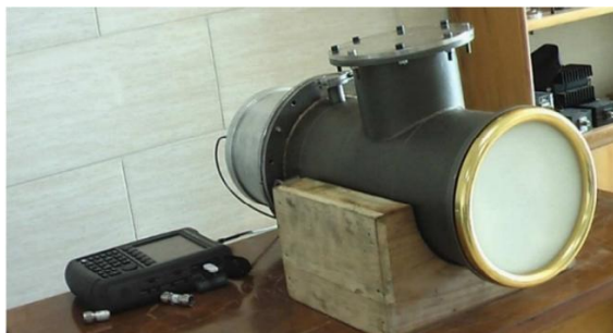
شکل (۱۲): اندازه‌گیری تلفات برگشتی آنتن
