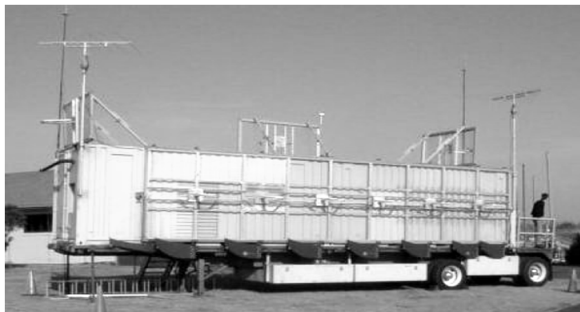
شکل ۹ - رادار غیر فعال تلویزیونی با برد ۲۴۰ کیلومتر وزاویه پوشش سمت ۶۰ درجه و ارتفاع ۵۰ درجه
