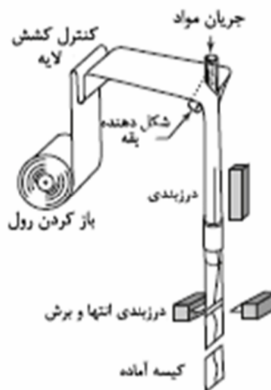
شکل ۳- ماشین عمودی برای بسته‌بندی مواد غذایی آماده ۱ به صورت پیوسته
