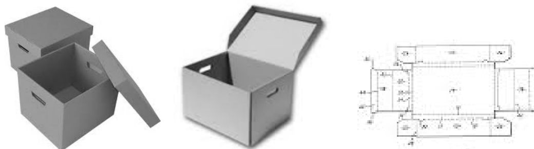
شکل ۱۲- تصاویری از طرح و شکل کارتن‌های مقوایی درپوش‌دار ۱ (سمت چپ)، مفصل‌دار ۲ (وسط) و باله‌دار ۳ (سمت راست)
