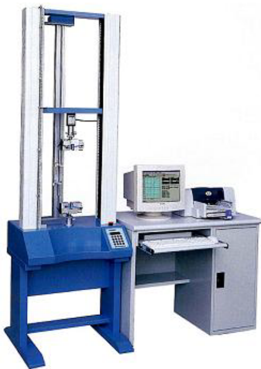
شکل ۷- دستگاه تعیین قدرت کششی کاغذ
