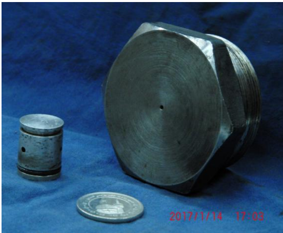
شکل (۵): الف) تصویر سمت چپ محافظه چرخش ب) سمت راست محافظه‌ی اصلی انژکتور طراحی و ساخته- شده.
