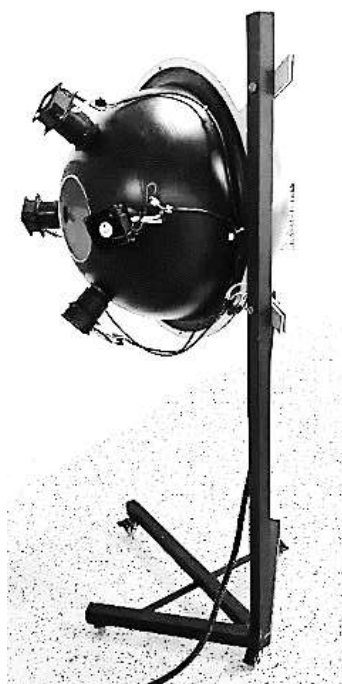
شکل (۱۲). طرح قرار گرفتن لامپ‌های هالوژن-تنگستن-کوارتز در کره ساخته شده
